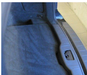
Volvo V50 med bagagerumsgolv någon centimeter under tröskelpanel
